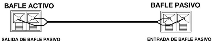
2. Conectar cada extremo del cable de interconexión en ambos bafles para el funcionamiento de las Luces LED.
