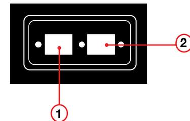
1) ENTRADA PARA CONEXIÓN DE CABLE DE LUCES LED (PASIVO).
