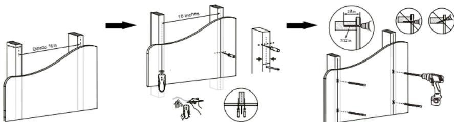
**Paso 2:** instalar el brazo de la placa a la pared, alinee el soporte con la pared e inserte los tornillos autorroscantes y las arandelas en los orificios guía; apriete lentamente los tornillos autorroscantes, nivele el soporte y, a continuación, apriete firmemente los tornillos autorroscantes; no apriete en exceso.
