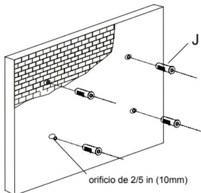
**Paso 2:** instale la placa de pared. Coloque la placa en la pared y luego atornille 4 tornillos autorroscantes en cada taquete a través de arandelas de metal para fijar el anclaje.
